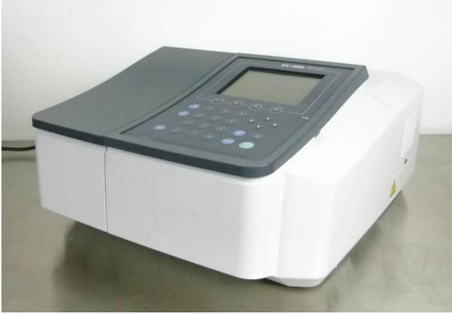
الشكل (7-3): جهاز مطياف (UV-Visible 1800).
